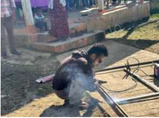
Fabrikasaun frame suporta solar sell nian no koko atu monta temporaria
