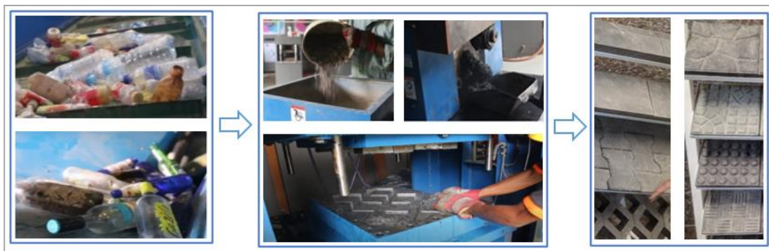
Figura 20 – Representação de transformação de resíduos plásticos e vidros em materiais de construção (tijolos de diferentes formas e modelos)
